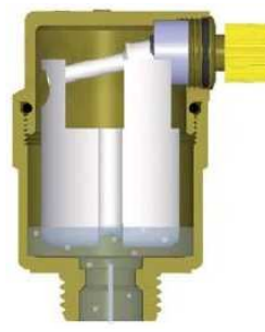
При наличии воздуха уровень воды опускается и поплавок открывает затвор
